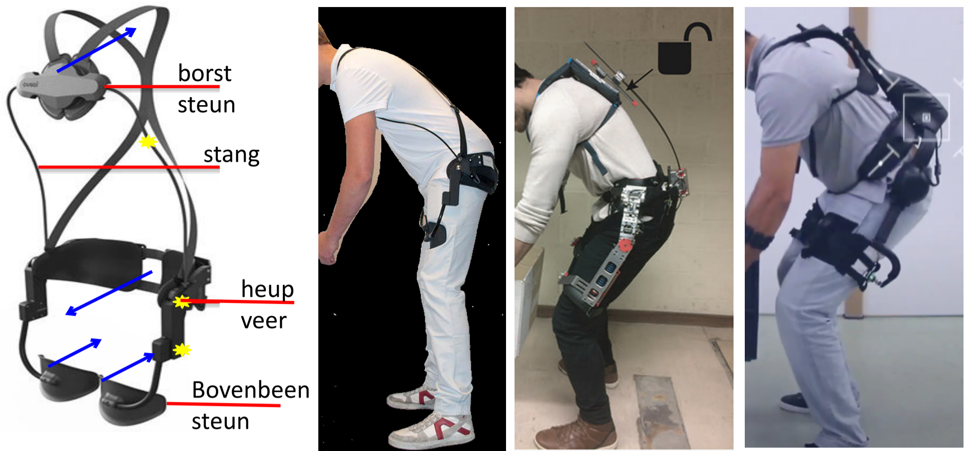
Figuur 2. (a) de Laevo, een commercieel verkrijgbaar 'passief' exoskelet. Passieve exoskeletten maken gebruik van veren. De blauwe pijlen geven aan waar het systeem op het lichaam kracht uitoefent om de rug te ondersteunen. (b) een gebruiker die een Laevo draagt. (c) Een recent ontwikkeld 'passief' exoskelet (SPEXOR). Het systeem heeft naast de veer bij de heup een buigend element bij de romp en draagt de kracht over via banden om de schouders. Het systeem levert meer ondersteuning dan de Laevo, maar is ook groter en zwaarder en nog niet uitontwikkeld. (d) een 'actief' exoskelet (Robomate) dat gebruik maakt van motoren bij de heupen.
