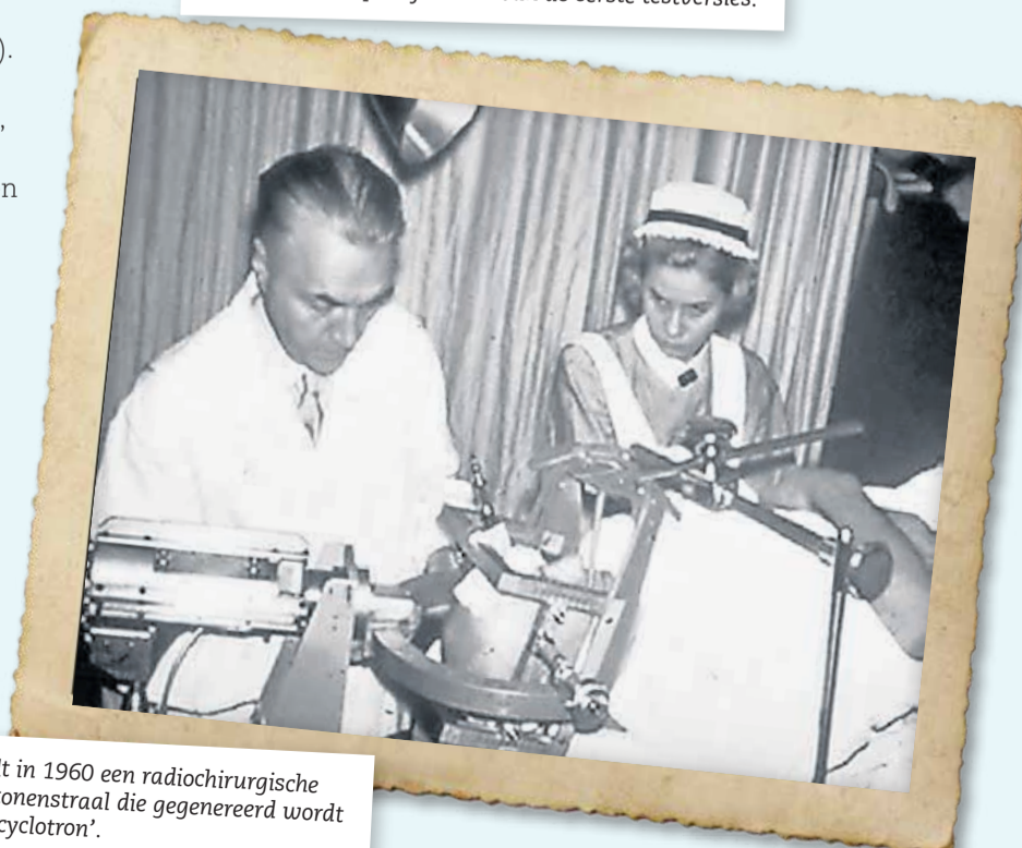
Leksell zocht naar alternatieve stralingsbronnen en ontwierp een apparaat dat werkt met kobalt-60, een radioactief isotoop dat gammastraling produceert: het gamma-mes. Op de foto een van de eerste testversies.
